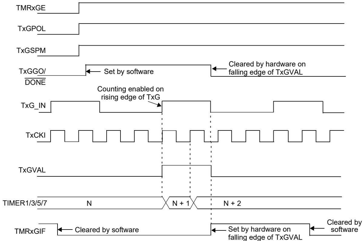
**Figure 26-7. TIMER1 GATE SINGLE-PULSE AND TOGGLE COMBINED MODE**
