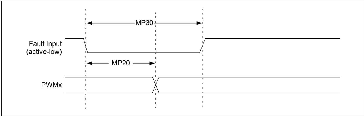
**FIGURE 30-10: HIGH-SPEED PWMx MODULE TIMING CHARACTERISTICS**
