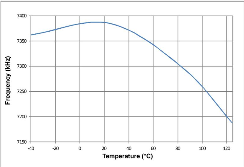
**FIGURE 31-10: TYPICAL LPRC FREQUENCY @ V<sub>DD</sub> = 3.3V**
