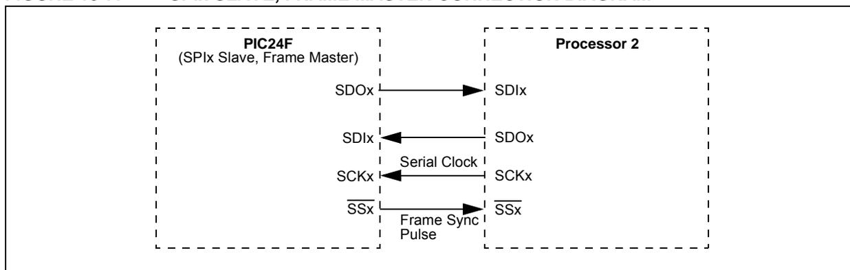
**FIGURE 18-8: SPIx SLAVE, FRAME SLAVE CONNECTION DIAGRAM**
