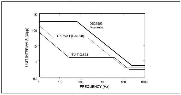
Figure 13-9. Jitter Tolerance (E1 Mode)
