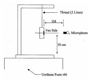
1 METER FROM MICROPHONE TO FAN INTAKE
