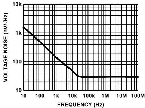
FIGURE 13. VOLTAGE NOISE vs FREQUENCY - VIDEO AMP
