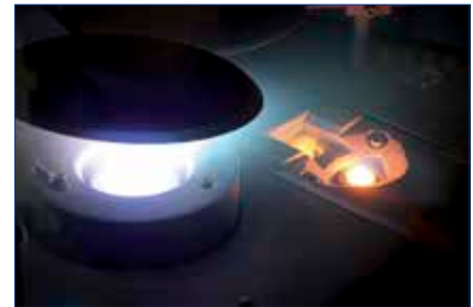
Beschichtungsanlage mit einem plasma-gestützten Elektronenstrahlverdampfer
