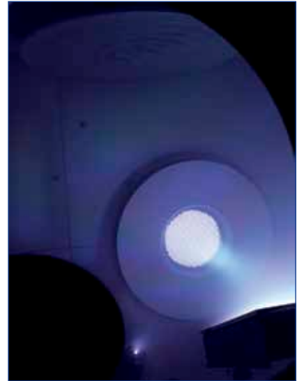
Ionenquelle eines Ionenstrahlverdampfers (Sputter)
